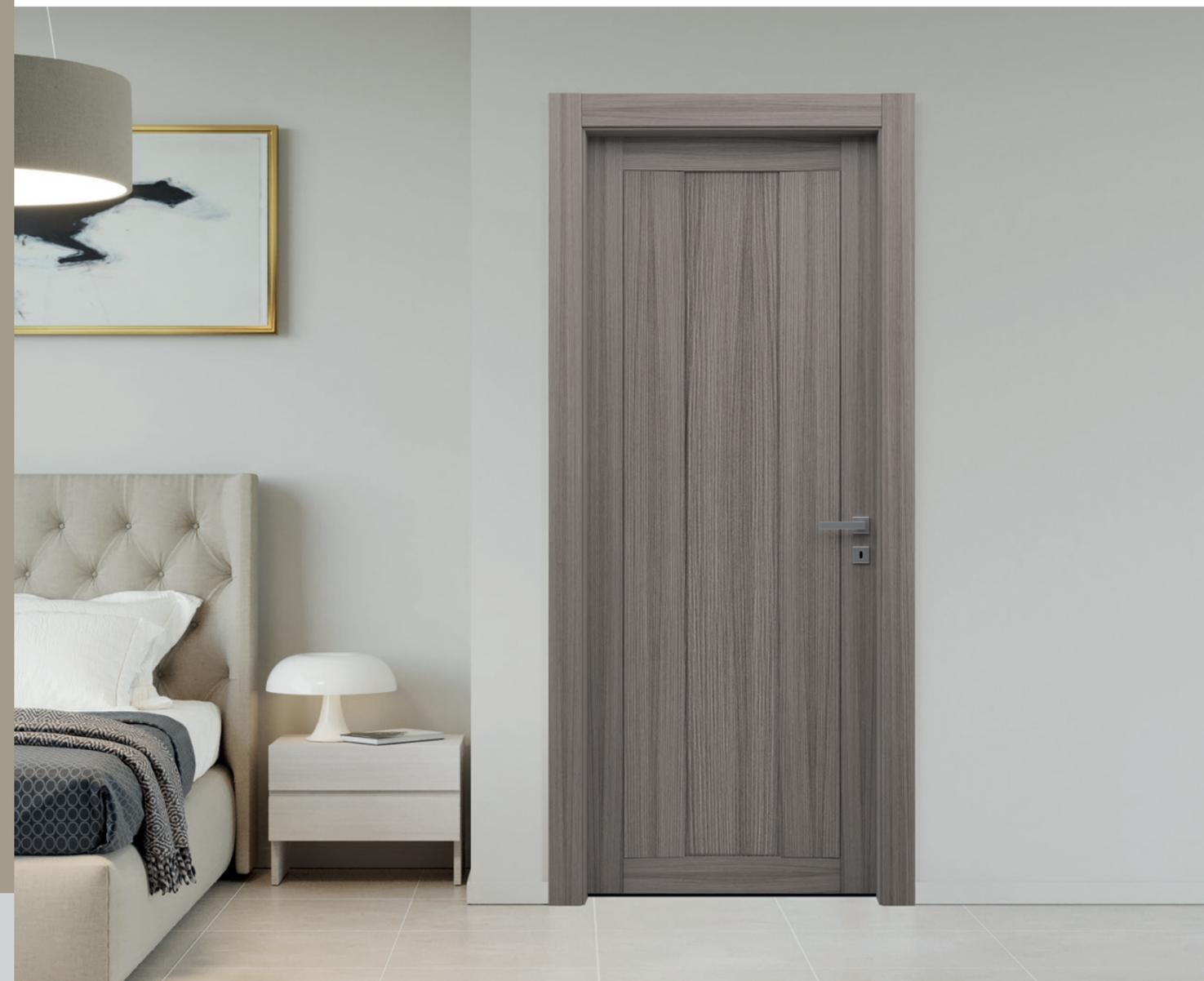
→ Rivestita in laminato antigraffio, è disponibile, anche su misura, con telaio tutto legno raggio 3 da 11 cm di spessore, guarnizione in battuta e coprifili telescopici tondi o piatti ad incastro.
